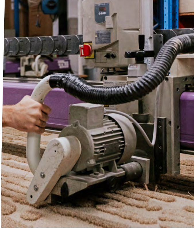
Rasage d'un tapis tufté. Limited Edition
